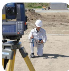
高速振動條件下的自動追蹤測試
